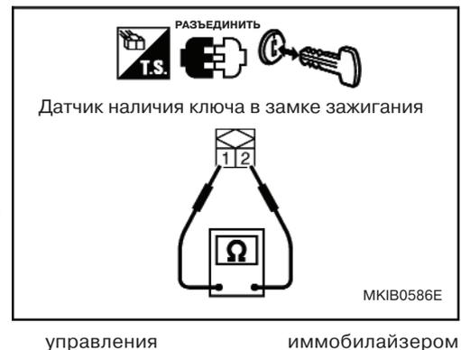
**НЕТ** >>Замените датчик наличия ключа в замке зажигания.
