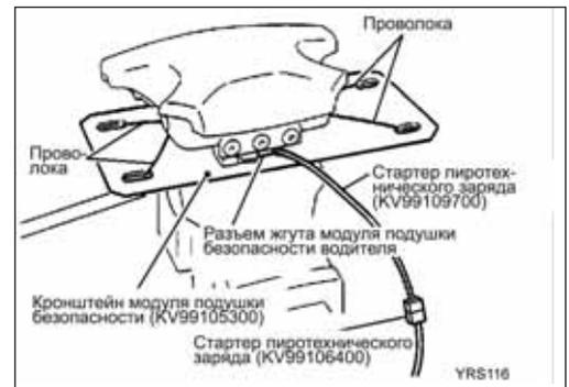
2. Жестко скрепите модуль подушки безопасности с кронштейном, зафиксированным в тисках.
