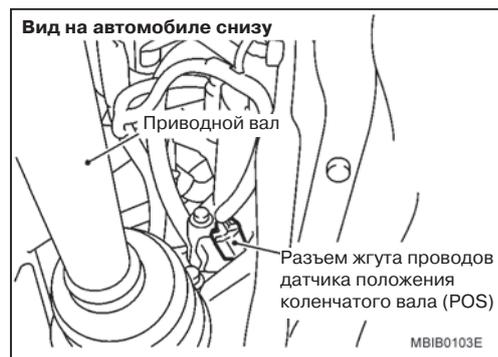
3. При помощи тестера CONSULT-II или мультиметра проверьте величину напряжения между контактом 3 разъема датчика положения (POS) коленчатого вала (СКР) и "массой".
