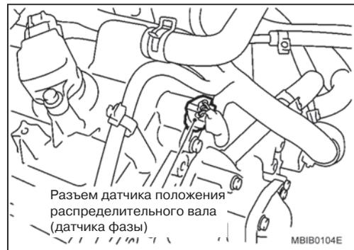
3. При помощи тестера CONSULT-II или мультиметра проверьте величину напряжения между контактом 3 разъема датчика положения (PHASE) распределительного вала (CMP) и "массой".
